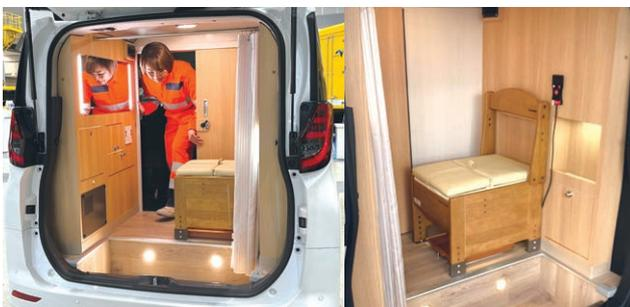
車両後部にトイレ機能を搭載。車内からトイレへ直接アクセスできます。
